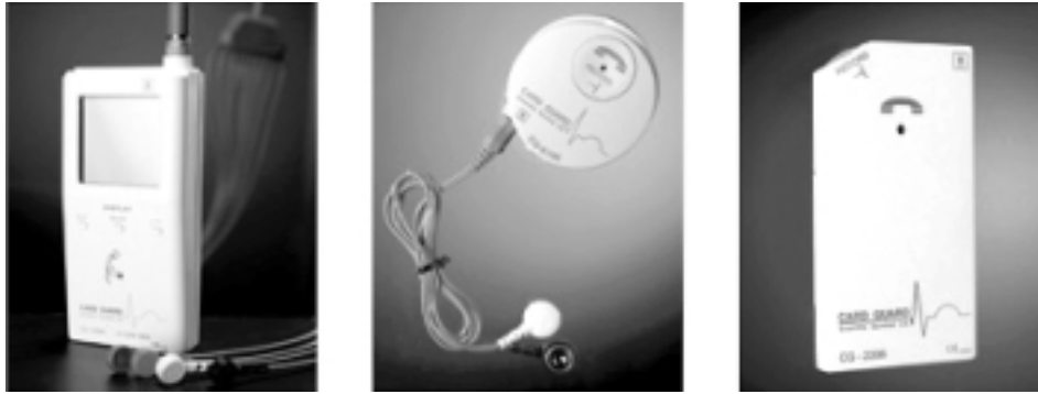
Figura 3. Dispositivi portatili per il monitoraggio telecardiologico domiciliare (home monitoring), dotati di capacità di registrazione, memorizzazione e trasmissione telefonica differita del segnale ECG. A sinistra, registratore di tracciati ECG standard a 12 derivazioni, con cavo paziente a 10 elettrodi, dotato di display per il controllo del tracciato; al centro, registratore a memoria continua detto "loop recorder", dotato di due cavetti collegati ad elettrodi monouso, che registra con memoria circolare e memorizza solo gli eventi attivati dal paziente; a destra, registratore con elettrodi integrati, quindi senza fili, posizionato sul torace dal paziente e attivato al momento dei sintomi, detto "event recorder".
